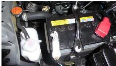
このM-42とは、調べてみました。アイドリングストップ車用のバッテリーで、Mは外形寸法区分、42は性能ランク、その後ろに端子位置が右側タイプのみRが記載されます。ちなみにMは通常バッテリーのB20サイズです。(B20は幅約127mm箱高200mm長さ20cm) 高性能バッテリーが搭載されるようになったのは、アイドリングストップ車だけではなく、燃費向上のために充電制御システムを搭載するようになり、従来車両の場合は走行時オルタネータから常に充電されていましたが、必要に応じて充電を制御し、余分な発電を減らすことでオルタネータによるエンジンの負荷を軽減し燃費向上を図っていて充電と放電を繰り返すバッテリーには過酷な環境になっています。(車両型式が「CBA」もしくは「DBA」で始まる)
