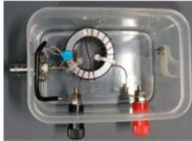
このバラに19.7mのワイヤーを付けて6mのタモ竿で持ち上げ2.5D2Vでフィード7/14/21/28MHzのマルチバンドアンテナが出来ました。その他運用状況はBYVのBLOGで
