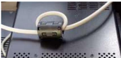
4個も付けなくても、1ターン1個で移動M AX50WまでOKでした。1ターン1個と4個通すだけとどちらがスマートかは個人の好みで、効果はばっちりでした。
