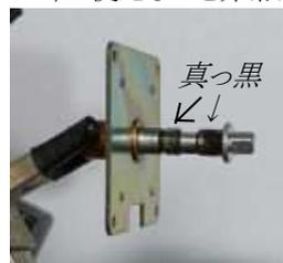
ロータリーエンコーダを取り外し ばらしてシャフトを押しても引いてもビクともしないので、今回はダメモトでネジの錆び落とし剤のネジザウルスリキッドを2滴ほどたらして数分後少～し動いた!
