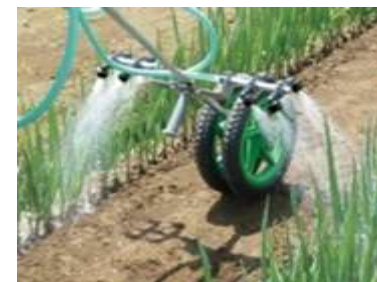
写真1 ねぎ用カートMK型 ノズル部を上下に移動できます。 (地上からノズル先端までの距離：約27～70cm)
