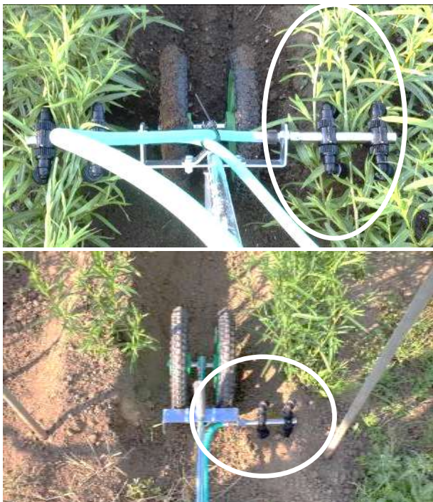
写真5 ネギカート散布時の状態 上: ノズル両脇では茎葉がなびき傷む 下: 片側にしたノズル
